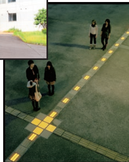
発光点字ブロック Light emitting Braille block
