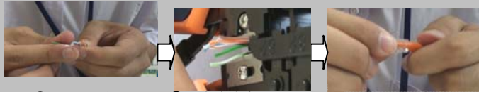
②順番に並べ ③長さを合わせ切断 ④端子を差し込む
